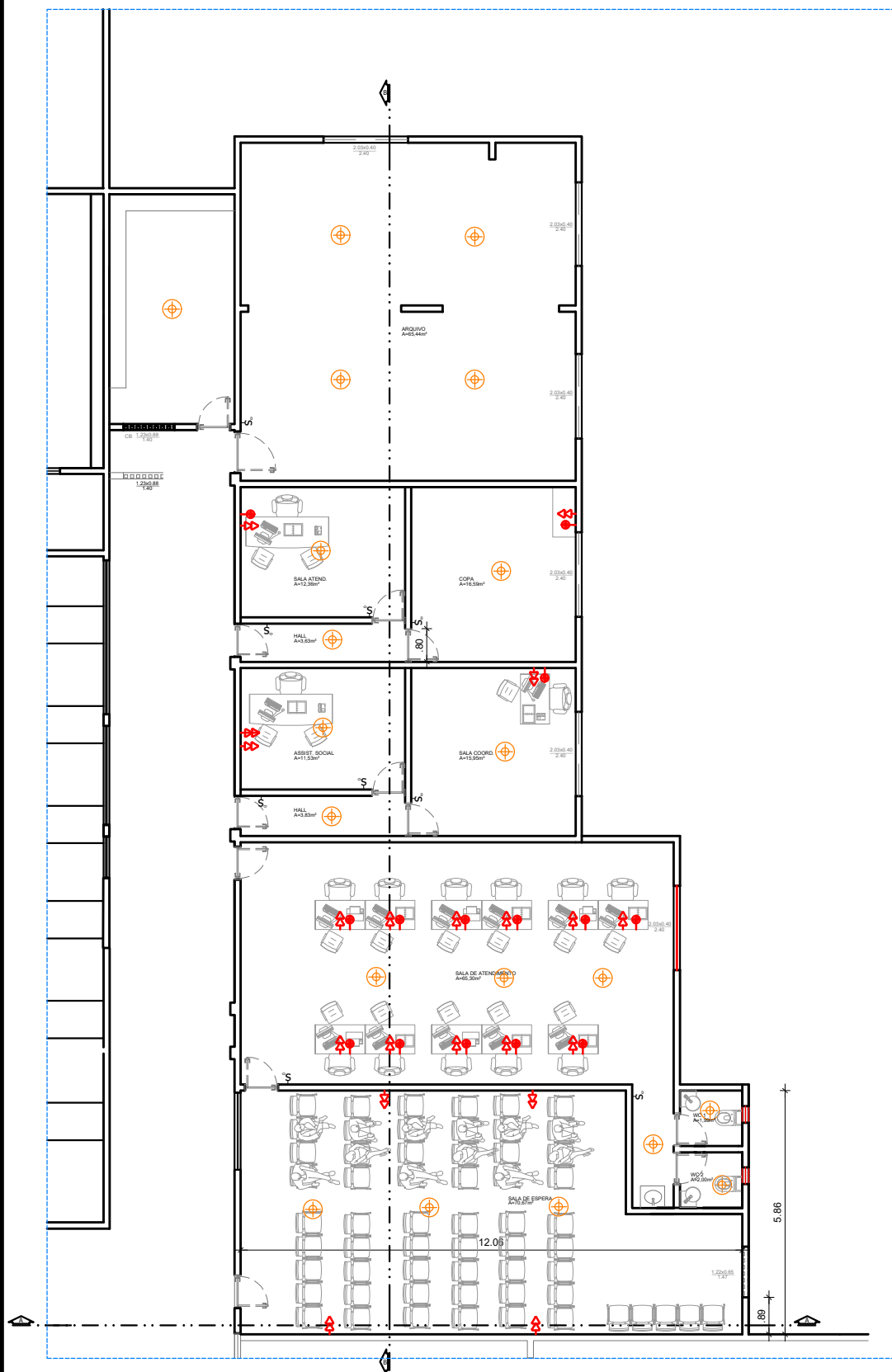
PLANTA DE PONTOS ELÉTRICOS ESC. _____/1250
